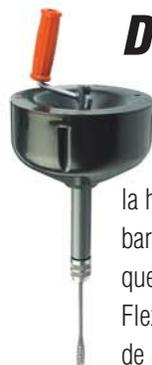
Manguito patentado que aprieta firmemente el cable con un cuarto de vuelta. La manivela se puede quitar para que la herramienta se pueda conectar a una barrena eléctrica. Recipiente duradero que contiene hasta 50 pies de cable Flexicore® de 1/4 pulg o 35 pies de 3/8 pulg.
